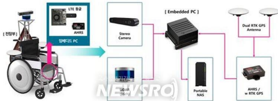
데이터 구축 전동 휠체어 자율주행을 위한 빅데이터 수집 장치
